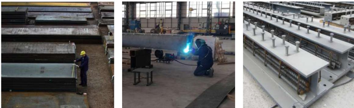
LAMIERE DA TRENO - TRAVI SALDATE REALIZZATE CON LAMIERA DA TRENO QUARTO -
