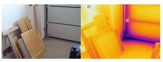
Tuttavia la prova sperimentale legata, ad esempio all'esecuzione di un «Blower door test» evidenzia come i nodi accoppiamento fra elementi portanti del portone e struttura edile siano fondamentali.
