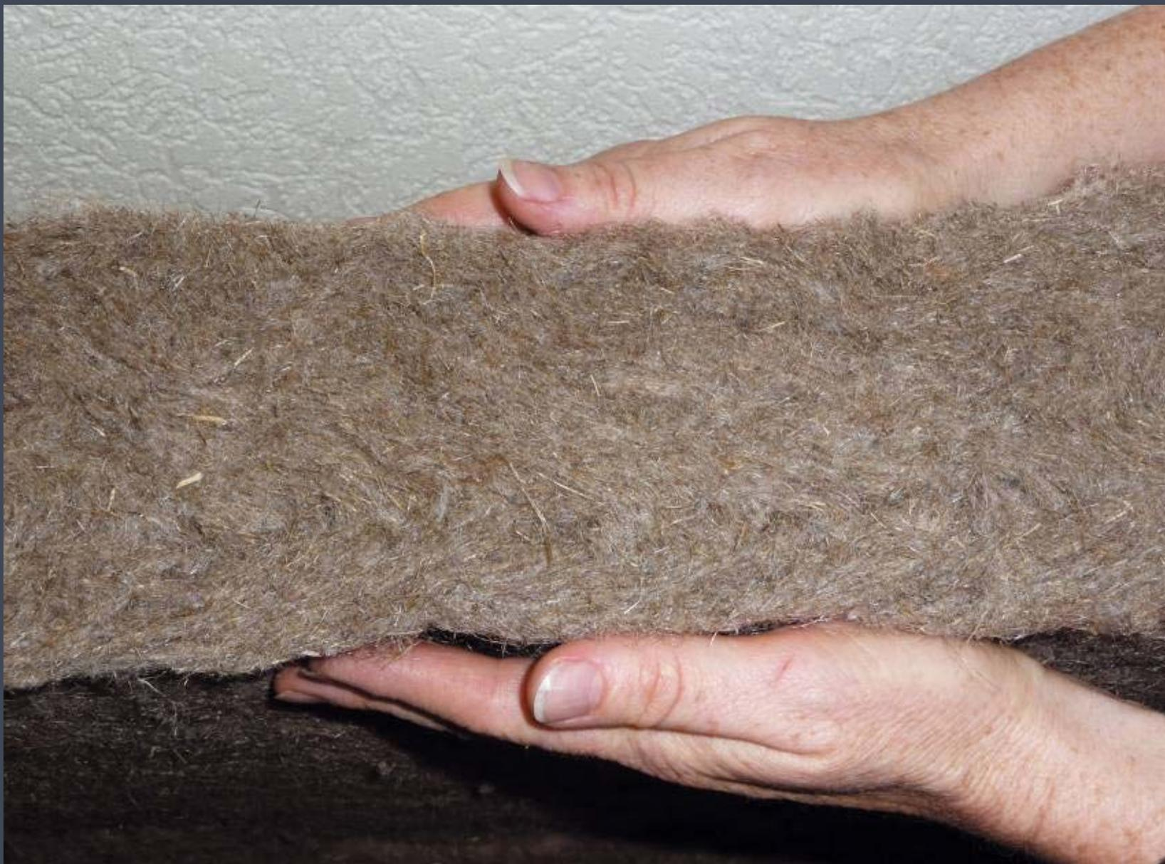
Isolante in fibre di lino e canapa, produzione Valnat:
