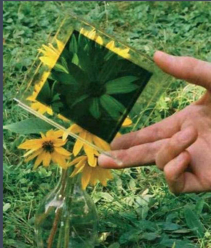
Dimostrazione del funzionamento dei vetri fotoelettrocromici sviluppati da Fraunhofer Institute for Solar Energy Systems (ISE) nel 2005-2006.
